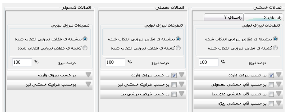
تصویر ۵-۱۳-۳: تنظیمات نیروهای طراحی اتصالات تیر به ستون
