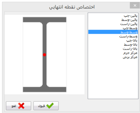
تصویر ۲-۸-الف: تنظیم محور تیرها
