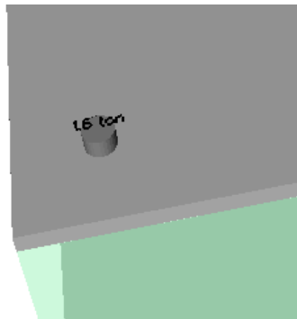
تصویر ۲-۵: مشاهده مقدار کشش متحمل شده توسط هر بولت
