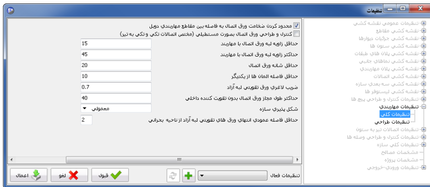
تصویر ۲-۲: پنجره تنظیمات کلی طراحی اتصالات مهاربندی
